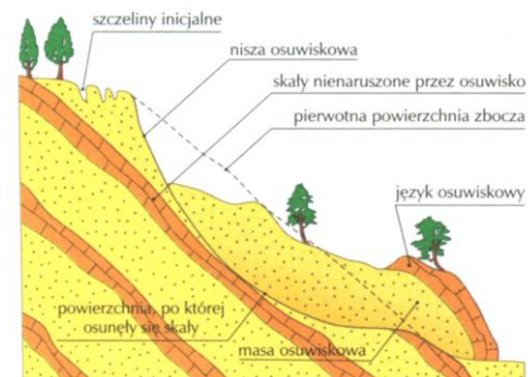
Rys. 30. Osuwisko w Karpatach Zewnętrznych
